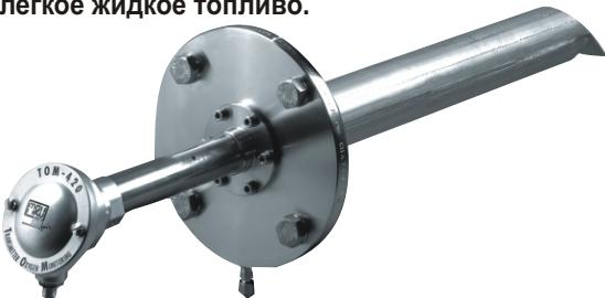
Газ для анализа, благодаря динамическому давлению потока уходящих газов, поступает на сенсор, находящийся в наконечнике трансмиттера TOM 420. Максимальная температура газа может достигать 1100°C, если газоотборный зонд изготовлен из высокотемпературной стали Inconel.
