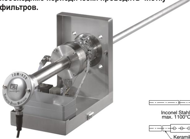
Такой зонд необходимо заказывать вместе с блоком управления и индикации CU 420. Эти устройства управляют нагревом фильтра (фильтр находится за фланцем) и продувкой его в определенных промежутках времени для автоматической чистки фильтра. Пробы газа из этого зонда можно использовать для последующего анализа (например CO<sub>2</sub>, CO, NO<sub>2</sub>, SO<sub>2</sub>) или возвратить в дымовой канал. Температурные ограничения зависят только от материала газозаборной трубы.
